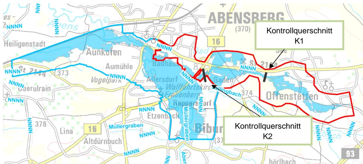
**Abbildung 7: Überflutungsflächen bei HQextrem (Proberechnung)**
