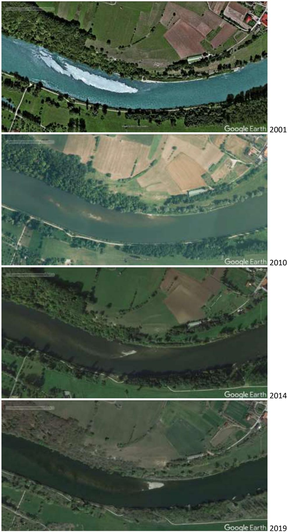
Abb. 30 Entwicklung der Kiesbank Staubing US7 (Luftaufnahmen aus google earth mit Aufnahmejahr, bei unterschiedlichen Abflüssen)
