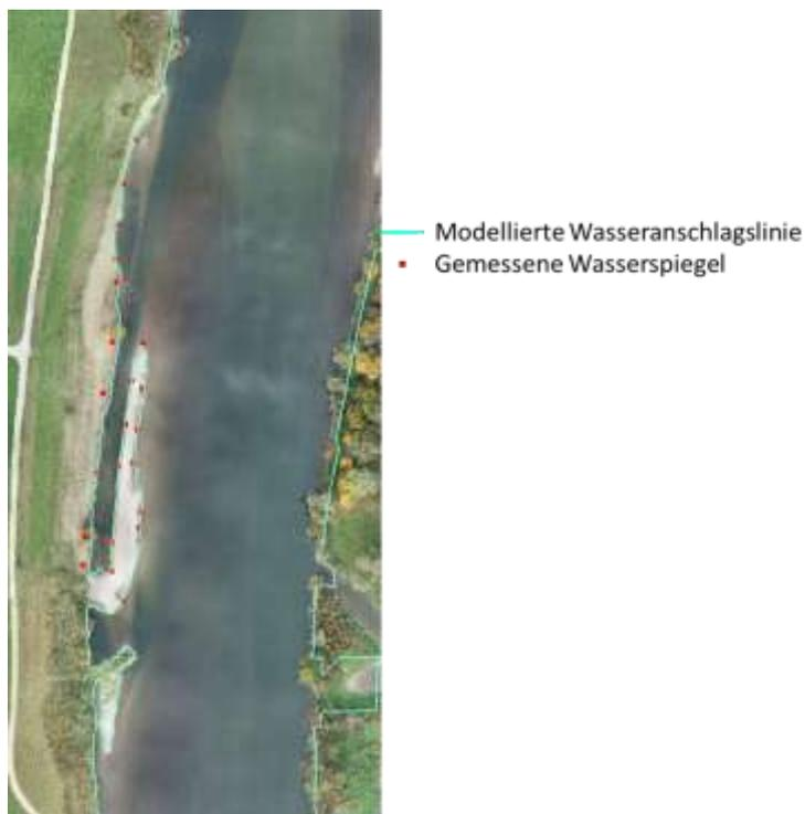
Abb. 15 Modellierte Wasseranschlagslinie (hellblau) und gemessene Wasserspiegel (rot) in US5 Eining links
