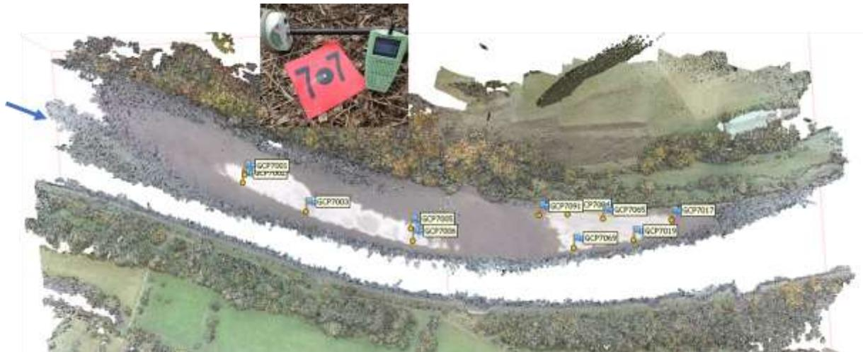
Abb. 9 Räumliche Punktwolke US7 Staubing links mit Fixpunkten, jede Flagge repräsentiert einen Ground Control Point und GPS-Gerät mit ausgelegtem GCP
