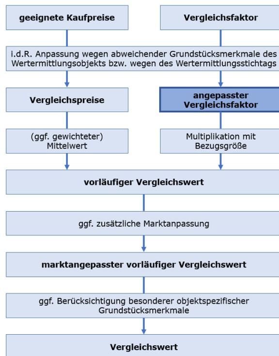
Abbildung 76: Ablaufschema Vergleichswertverfahren gemäß VW-RL
